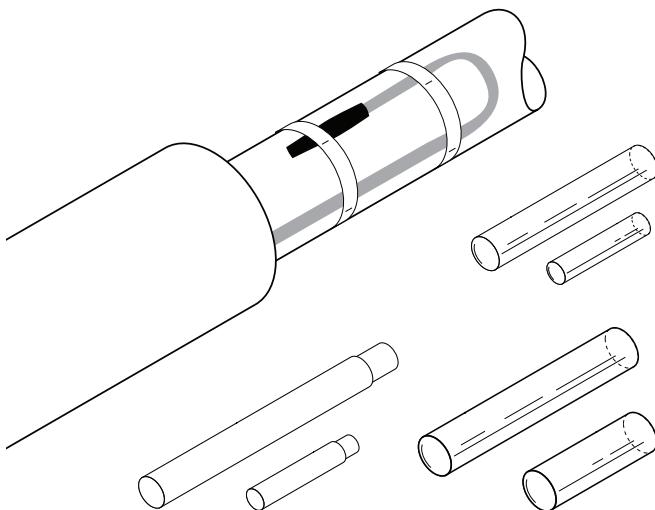
Эти сертифицированы для применения во взрывоопасных зонах термоусаживаемые наборы предназначены для оконцевания под теплоизоляцией саморегулируемых греющих кабелей nVent RAYCHEM.
