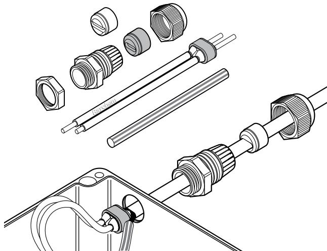
Подсоединительные наборы C25-100 предназначены для подсоединения греющих кабелей BTV, QTVR, XTV, KTV или VPL к соединительной коробке с обеспечением электрической изоляции медных жил и саморегулируемого греющего элемента греющего кабеля.
